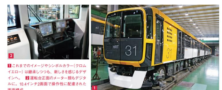
1 これまでのイメージカラー(クロムイエロー)は継承しつつも、新しさを感じるデザインへ。 2 運転台正面のメーター類もデジタルに。10.4インチ2画面で操作性に配慮された画面構成。
